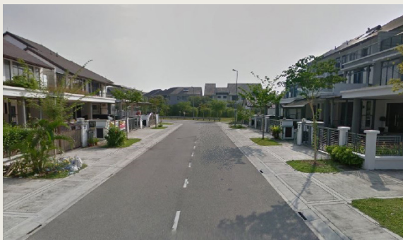
Foto 5.21: Berkesinambungan, selesa dan selamat: Laluan pejalan kaki tidak diganggu oleh kereta dan berkesinambungan dari satu rumah ke satu rumah
