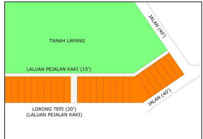
Rajah 3: Ilustrasi penyediaan lorong belakang bagi deretan rumah yang membelakangkan tanah lapang.
