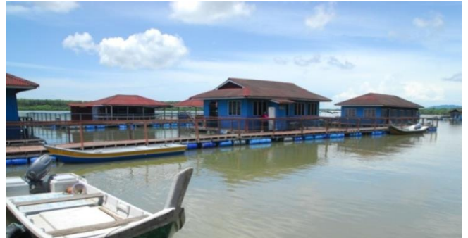
Foto 8: Pembangunan chalet atas air di sungai yang dibina di atas tong dram kosong (Teluk Bayu Floating Chalet, Sungai Merbok, Kedah)
